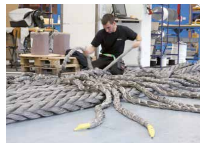
Da geht noch mehr: Sonderanfertigung einer Megaschlinge mit 900t WLL Beyond the limits: a megasling with 900t WLL being custom-made
