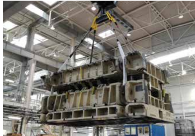
Wechsel eines Presswerkzeugs in der Automobilindustrie Changing of a pressing tool in the auto industry
