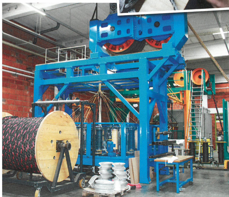
Große Anlage zum Flechten von Seilmänteln: der Mantelflechter bei Gleistein. Fotos: Gleistein Ropes, Carl Stahl Hebeteknik GmbH, tp
